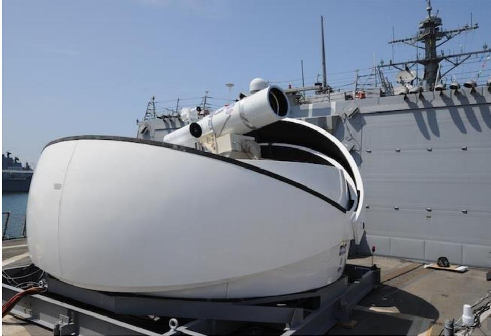
Sistema Laser a stato solido a energia diretta scalabile in potenza prodotto dalla **Northrop Grouman & Raytheon**, installato sulla USS Ponce.
